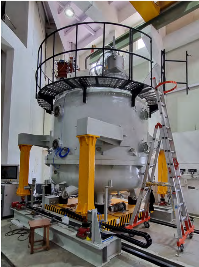
चित्र 23: गुरुशिखर, माउंट आबू में पीआरएल माउंट आबू वेधशाला में स्थापित 2.5 मीटर व्यास वाले दर्पण के लिए दर्पण लेपन संयंत्र।
