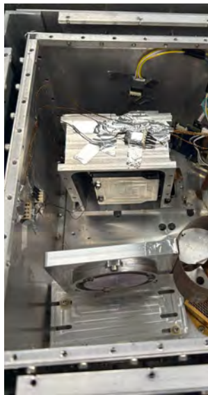
चित्र 28: Y फ़िल्टर के साथ H2RG डिटेक्टर का उपयोग करके इमेजिंग के लिए सेटअप।
