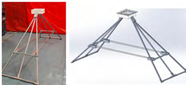
Fig.: no. 13: Long Wave Array Antenna (LWA) for USO
