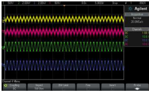
चित्र 3: (अ) 730 हर्ट्ज आवृत्ति और 10 mV आयाम (पीले रंग में) वाले फंक्शन जनरेटर साइन-वेव से इनपुट (ब) पावर लाइन फिल्टर और प्री-एम्पलीफायर का आउटपुट (गुलाबी रंग में) (स) 730 हर्ट्ज असतत आवृत्ति फिल्टर का आउटपुट (हरे रंग में) (द) वाइड बैंड फिल्टर का आउटपुट (नीले रंग में)
