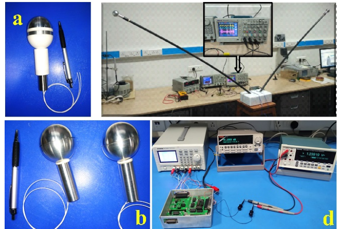
चित्र 26: (a) लैंगम्यूअर प्रोब और (b) इलेक्ट्रिक फील्ड सेंसर (c) इलेक्ट्रिक फील्ड एफई विशेषीकरण (d) लैंगम्यूअर प्रोब इलेक्ट्रोमीटर विशेषीकरण का प्रोटोटाइप डिज़ाइन
