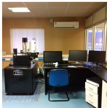
चित्र 18. SEM- \mu रमन स्पेक्ट्रोमीटर के लिए प्रयोगशाला।
