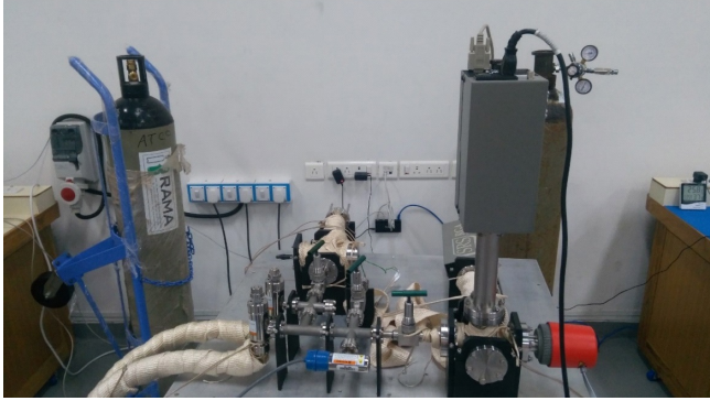
चित्र 44: द्रव्यमान स्पेक्ट्रोमीटर के परीक्षण और अंशांकन के लिए परीक्षण सेटअप
