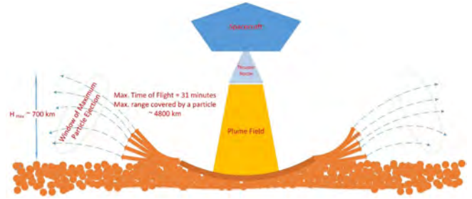
चित्र सं. 10 : अंतरिक्ष यान लैंडिंग के दौरान चंद्रमा की सतह से धूल निष्कासन का चित्रण
