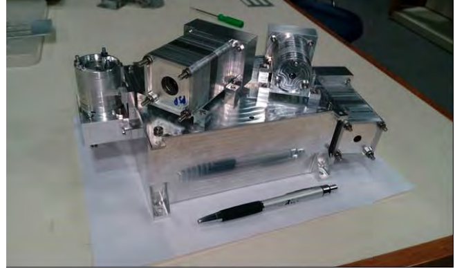
चित्र सं. 22: STEPS-1 पैकेज (इलेक्ट्रॉनिक्स के बिना) के लिए यांत्रिक मॉडल, आकार: 290 मिमी x 155 मिमी x 124 मिमी
