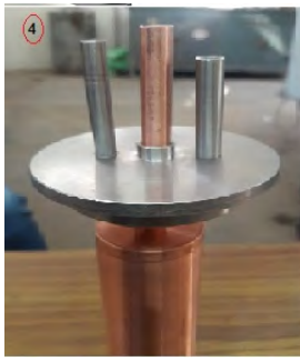
चित्र 7: छोटे डिटेक्टर परीक्षण के लिए तापमान क्रायोस्टैट का प्रारंभिक डिजाइन
